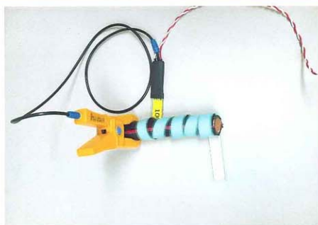
高圧(6.6kV)ピックアップと無機ELテープ
