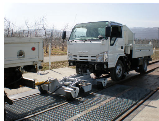
救援軌陸車により台車を牽引し、故障した軌陸車を搬送、脱出
