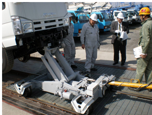
故障した軌陸車を牽引台車に搭載した油圧ジャッキで持ち上げ固定
