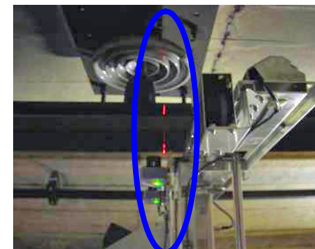
2次元レーザによるトロリ線磨耗測定
