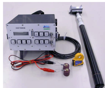
列車検知装置の電流測定器 (東日本電気エンジニアリング)
