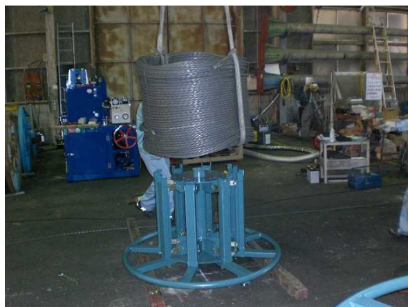
開発したドラムの片側のツバを外し電線の抜取り
