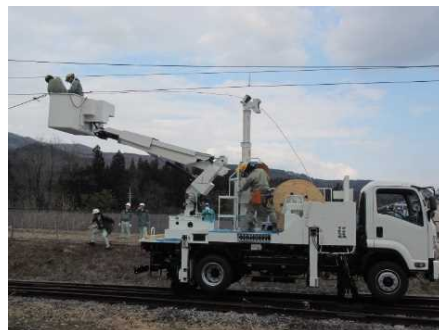
開発した次世代型トロリ線張替作業車
