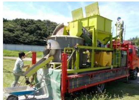
技術開発による施工の効率化 (車載式コンクリート練り製造装置の開発)
