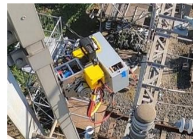
(※1) 架空送電工事用ロボットの開発
