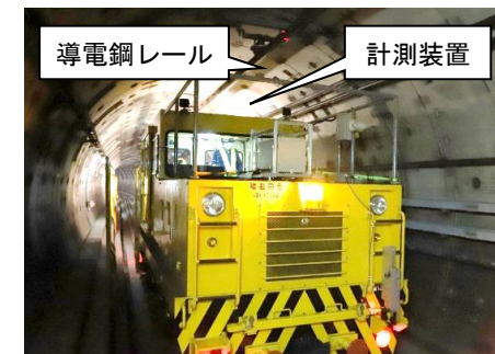
剛体電車線用摩耗測定装置の開発
