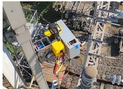
技術開発による施工の効率化 (架空送電工事用ロボットの開発)
