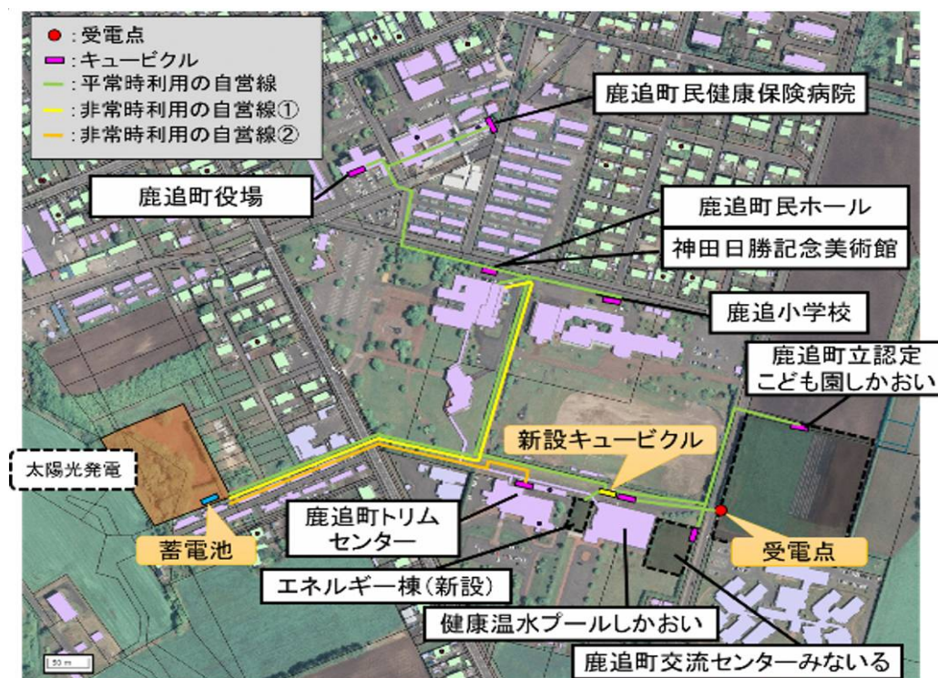
鹿追町自営線ネットワーク（配電網概要図）
